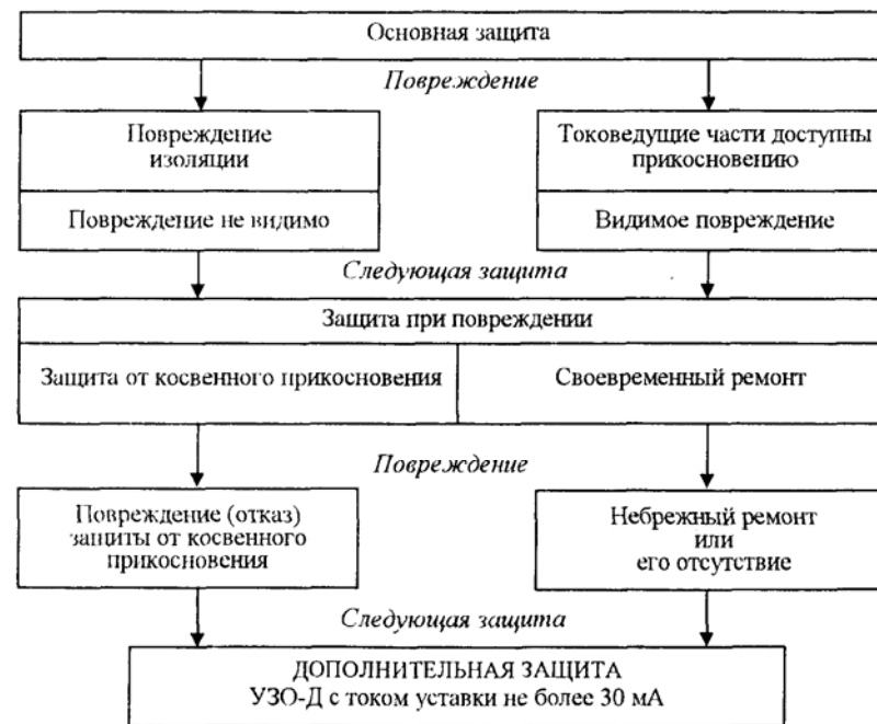
Рис. 4.1. Меры защиты от поражения электрическим током
