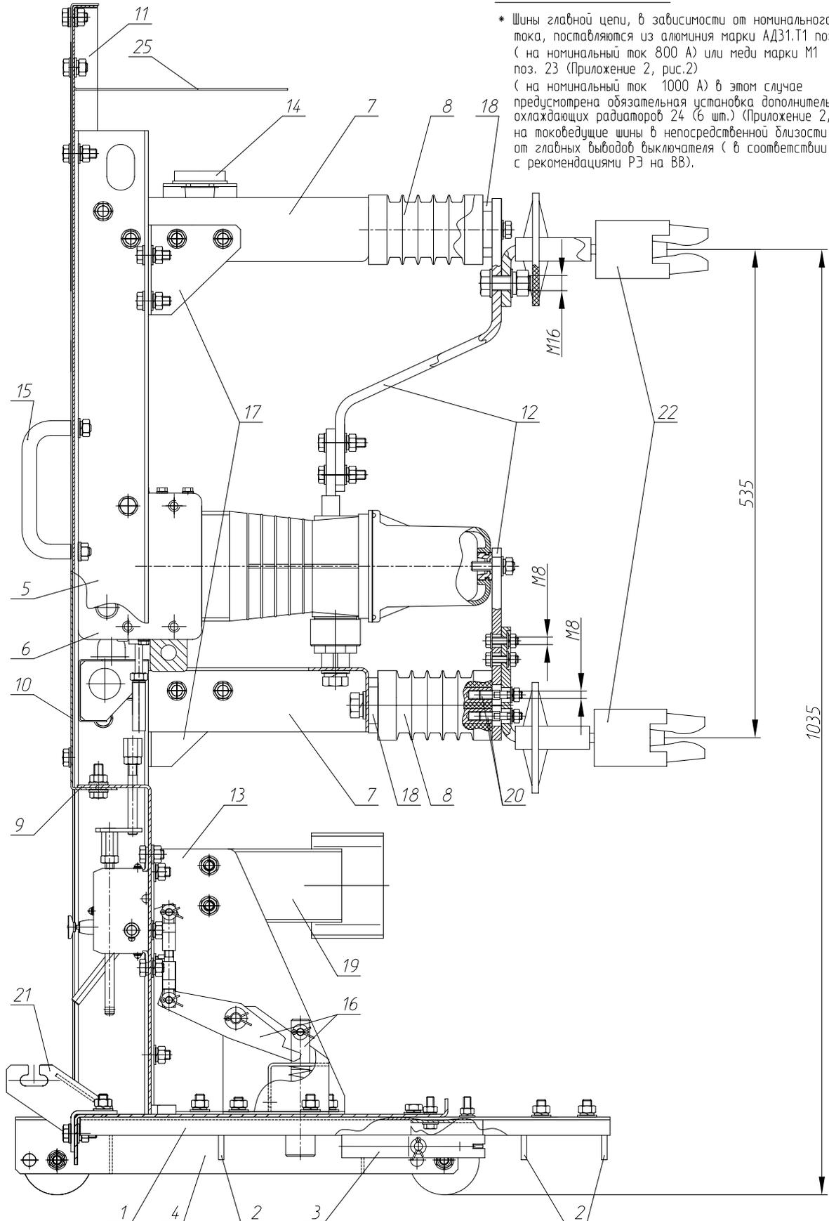
\* Шины главной цепи, в зависимости от номинального тока, поставляются из алюминия марки АД31.Т1 поз. 12 ( на номинальный ток 800 А) или меди марки М1 поз. 23 (Приложение 2, рис.2) ( на номинальный ток 1000 А) в этом случае предусмотрена обязательная установка дополнительных охлаждающих радиаторов 24 (6 шт.) (Приложение 2, рис. 2) на токоведущие шины в непосредственной близости от главных выводов выключателя ( в соответствии с рекомендациями РЭ на ВВ).
