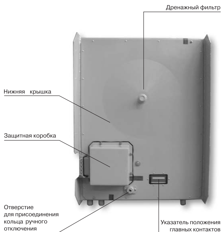
Коммутационный модуль - вид снизу
