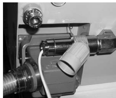
Подключение соединительного кабеля и кабеля питания
