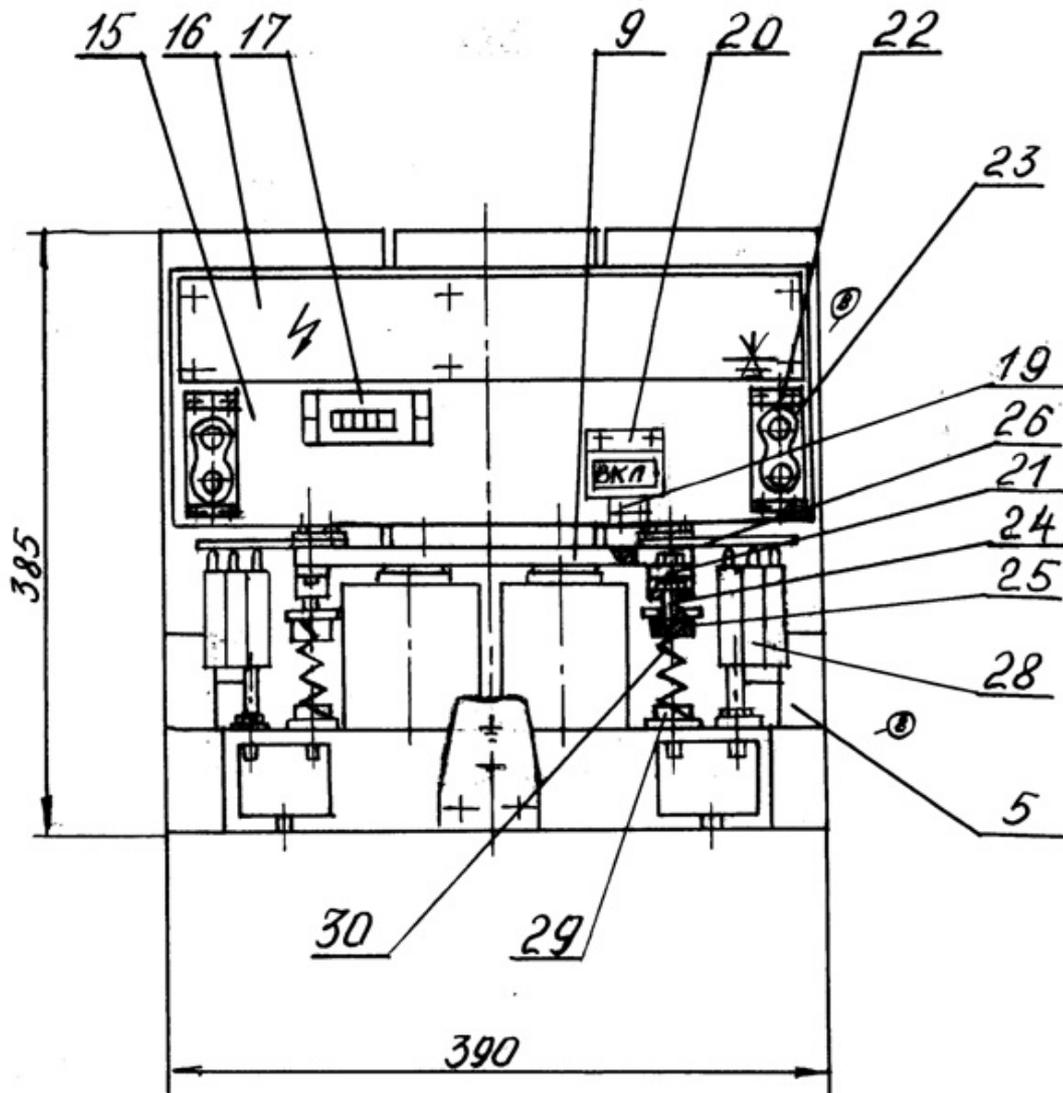
3.3.4 Механически связанные с приводом группы контактные (далее – ГК) состоят из шести пар, каждая из которых содержит общую подвижную перемычку, с помощью которой при включении привода замыкаются нормально замкнутые и замыкаются нормально разомкнутые контакты, при отключении привода происходит обратный процесс.
