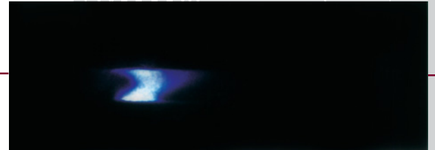
Горение дуги в радиальном и осевом магнитном поле
