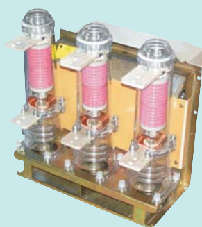
Рис.1.4. Выключатель вакуумный на номинальные токи до 1000А и токи отключения до 20кА с пружинно-моторным приводом
