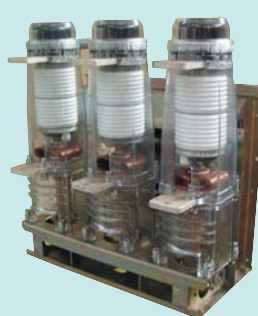
Рис.1.5. Выключатель вакуумный на номинальные токи до 1600А и токи отключения до 20(31,5) кА с электромагнитным приводом
