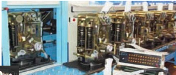
Привод выключателя на сборочном конвейере
