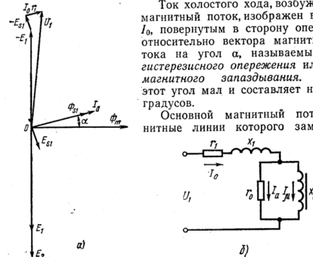
Рис. 18. Векторная диаграмма (а) и эквивалентная схема (б) трансформатора при холостом ходе
