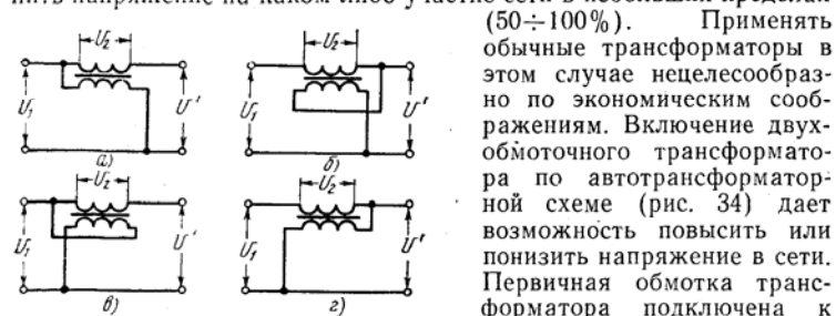
Рис. 34. Схемы включения двухобмоточного трансформатора по автотрансформаторной схеме:
