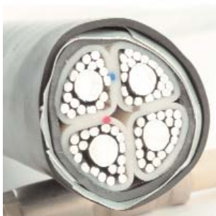
Примеры срезов кабеля секторными ножницами
